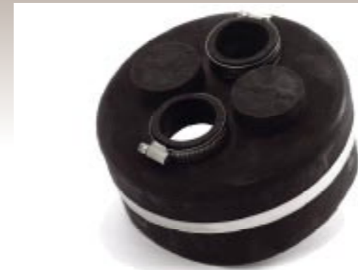
Muovitech suojaputken kansi 140, kumia Ø 40 Sopii suojaputkeen 139,7 Vakiotoimituksessa kaksi poistoaukkoa (Ø 40), mahdollisuus lisätä kaksi aukkoa Tuotenro 1030-140
