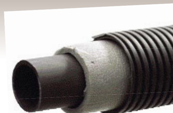
Eristetty putki Muovitech 40/63 PEM 40PN8 SDR17 putki, jossa eristys ja aallotettu ulkokuori. Tuotenro 54063Iso
